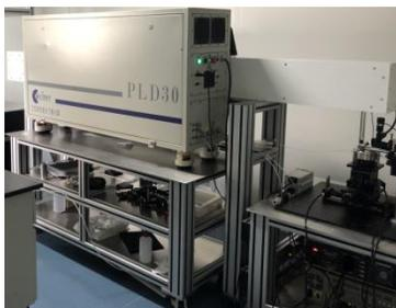
准分子激光微区剥蚀系统
